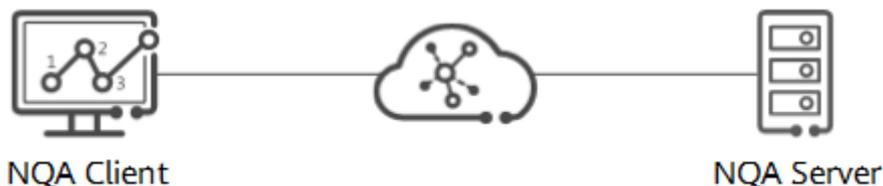
在NQA测试中，将发起NQA测试的源端称为NQA客户端，测试的目的端称为NQA服务器端。为使NQA客户端能够发起NQA测试，用户需要在NQA客户端中创建各类型的测试实例，构造符合相应协议的报文并打上时间戳，再发送至服务器端。
