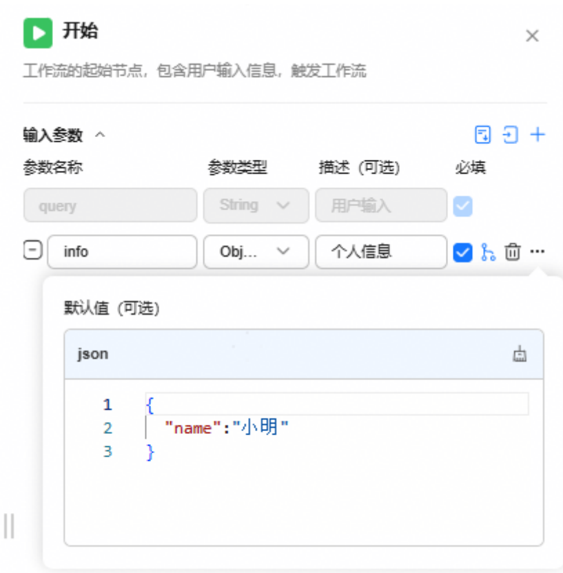
图 8-44 开始节点 Object 类型参数
