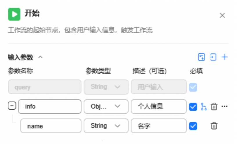
图 8-43 开始节点 Object 类型参数嵌套
