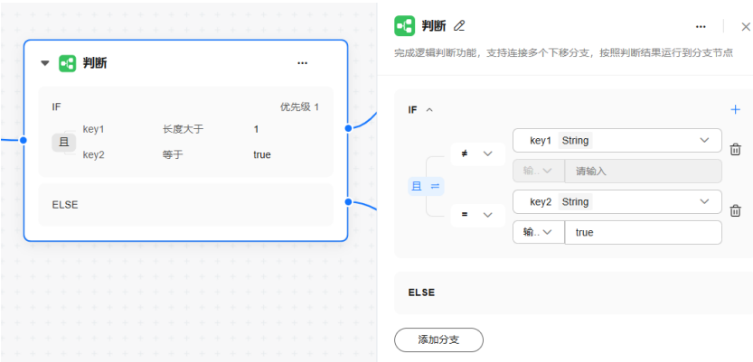
图 8-49 判断节点配置示例
