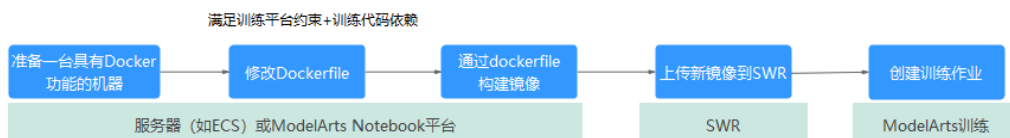
图 10-21 训练作业的自定义镜像制作流程
