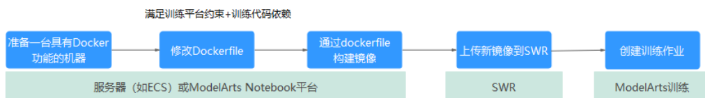
图 8-4 训练作业的自定义镜像制作流程
