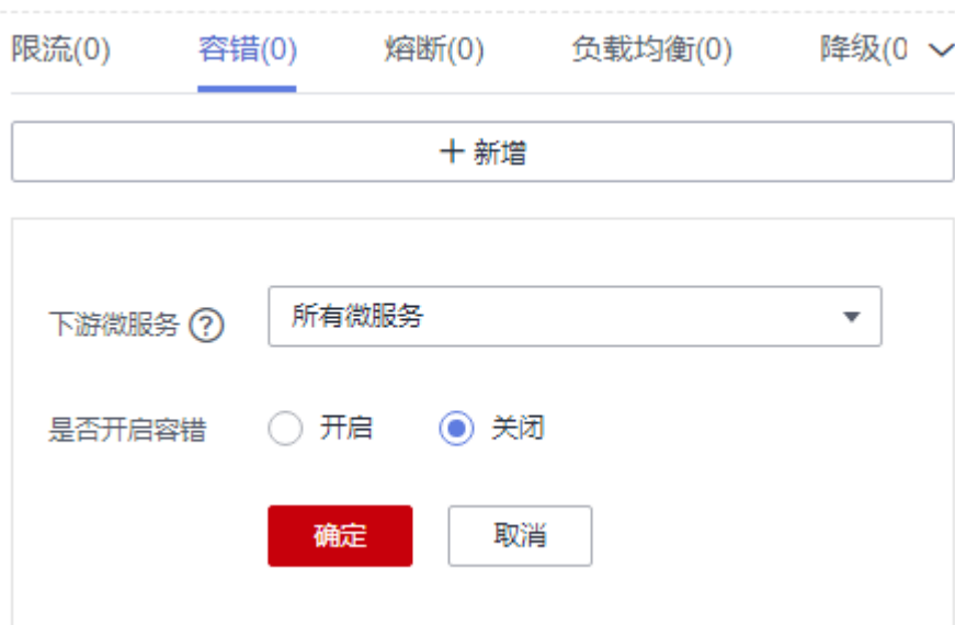
图 12-7 设置容错（Spring Cloud 开发框架接入的微服务）
