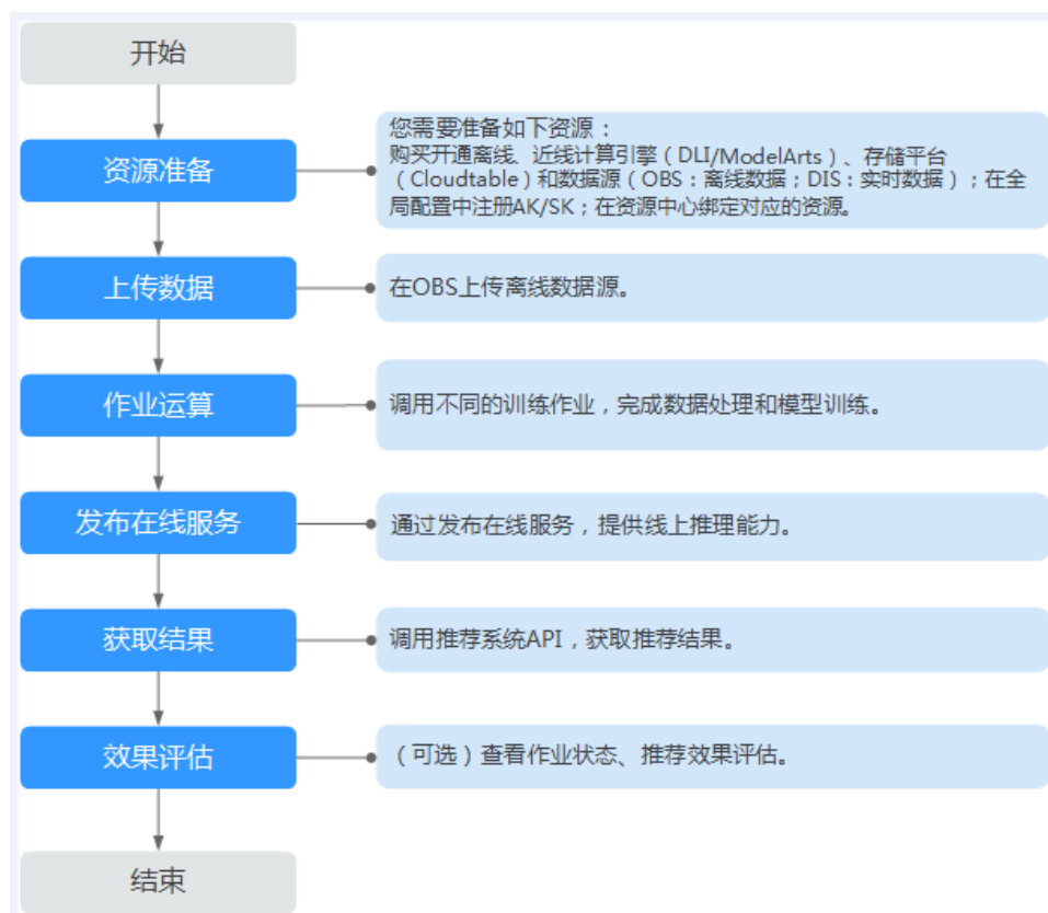
图 8-5 RES 操作流程
