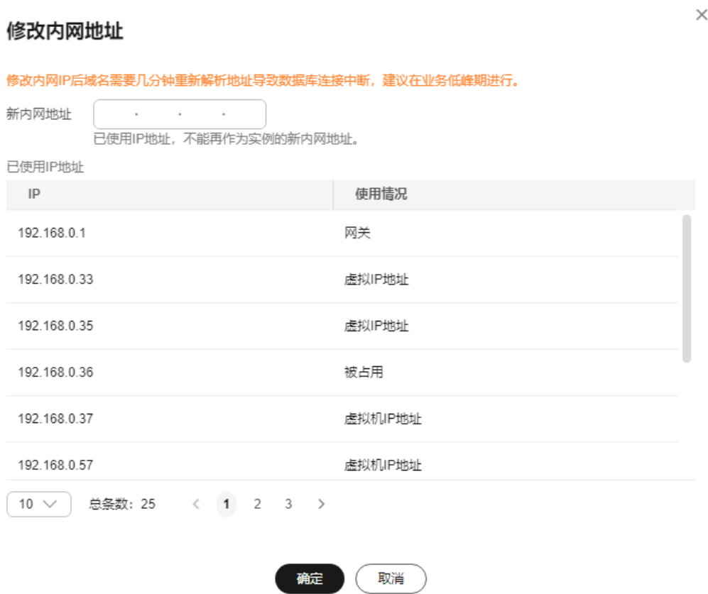
图 3-102 修改内网地址
