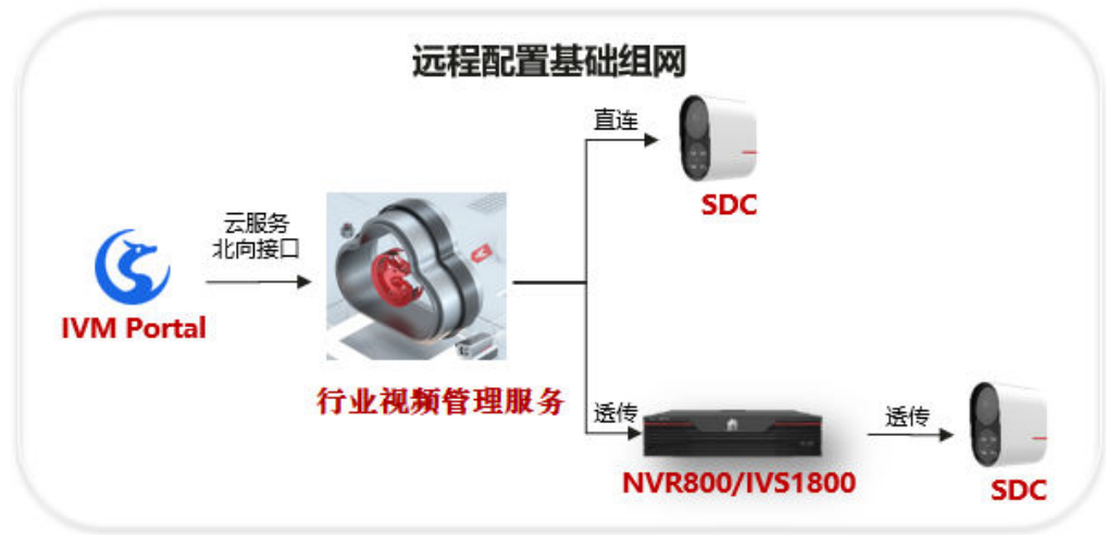
图 5-1 远程配置基础组网
