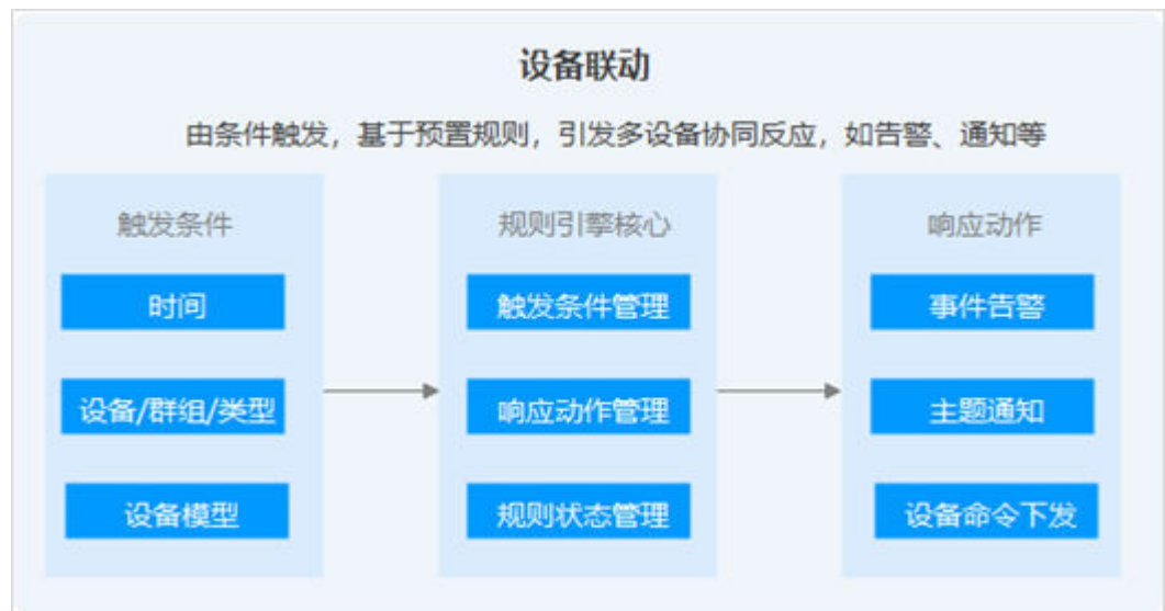
图 7-116 设备联动架构图
