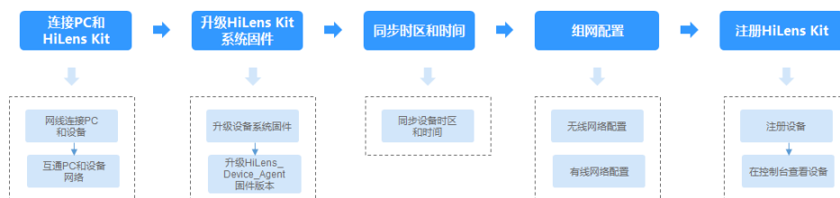
图 6-2 智能边缘系统注册设备流程
