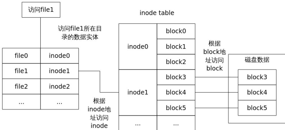
内核ext4校验使用checksum校验inode信息，当出现分区表错误、磁盘硬件损坏时，内核返回-EIO错误码，系统上报EXT4-fs error checksum invalid错误。
