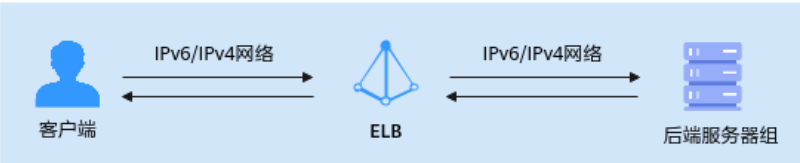
图 1-8 TCP 和 UDP 协议开启 IPv4/IPv6 地址转换业务架构图
