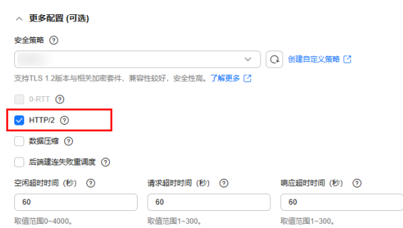
图 1-21 开启 HTTP 监听器的 HTTP/2 功能
