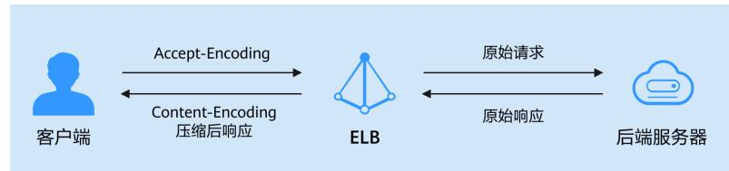
图 1-19 后端服务器进行压缩示意图
