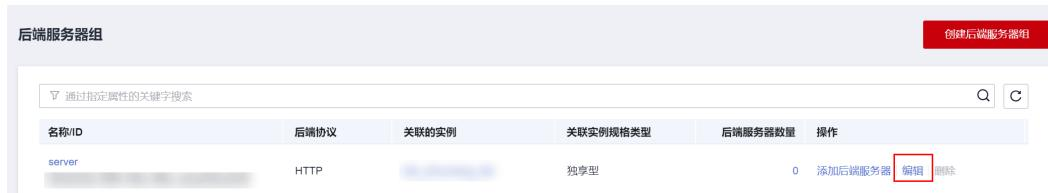
6. 在“修改后端服务器组”弹窗中，开启慢启动功能并配置慢启动时间。
