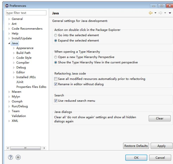
3. 在左侧菜单栏选择“Java > Installed JREs”配置JDK环境变量，显示如图2-2所示。
