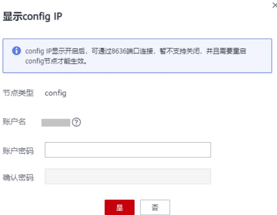
config IP开启后，需要重启对应config节点才能生效。
