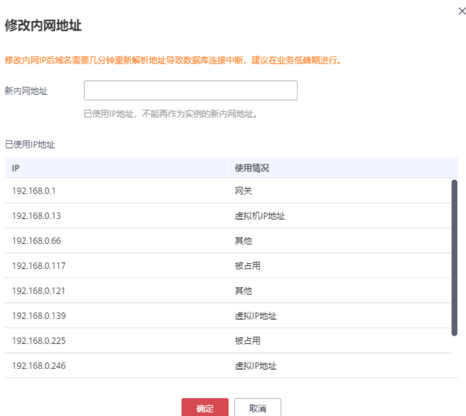
图 5-7 修改内网地址
