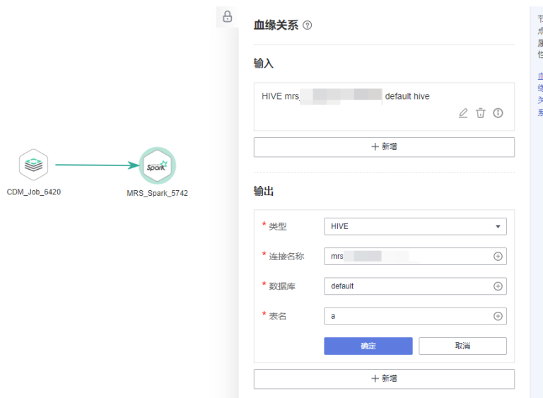
图 12-35 配置血缘输出
