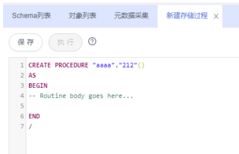
图 7-25 新建存储过程
