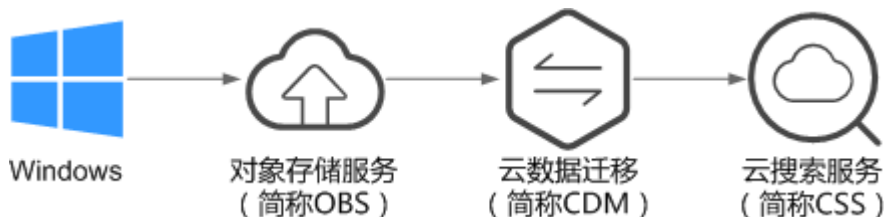
图 2-17 使用 CDM 从 OBS 导入数据到 Elasticsearch 时的数据传输流程
