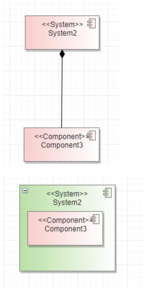
System下层子元素按架构配置方案只能是Subsystem、Domain、Service、MS 图中是Component。
