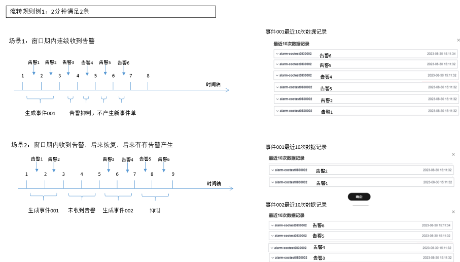
图 8-20 流转规则转事件/告警示意图
