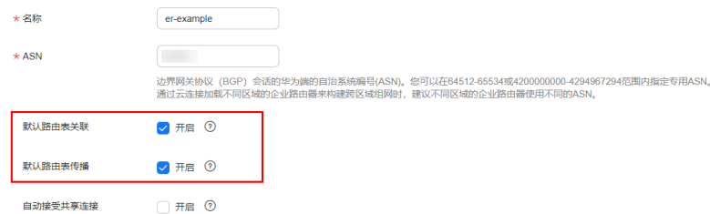
图 2-4 企业路由器开启默认路由表互联和默认路由表传播功能
