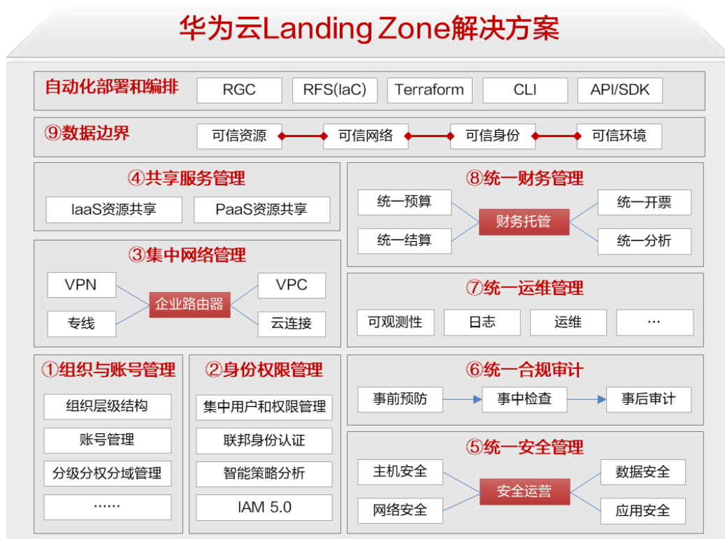
图 3-12 Landing Zone 解决方案参考架构
