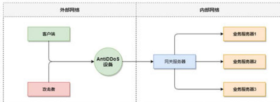
如图2-13所示，华为云解决方案通过在UDP报文中增加水印头部信息，用以标识正常的业务报文，线下AntiDDoS设备在接收到UDP报文后，通过检查UDP水印的正确性，可以高效准确放行正常的业务报文，阻断攻击报文。
