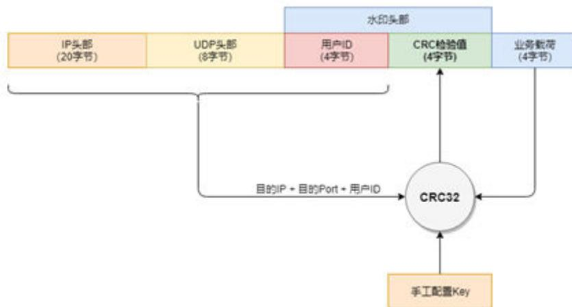
客户端和AntiDDoS设备需要使用相同的信息结构和计算规则，其中计算规则是指计算水印值的哈希因子和哈希算法，在本方案中，哈希因子使用了目的IP、目的端口、用户标识和水印关键字，哈希算法使用CRC32。
