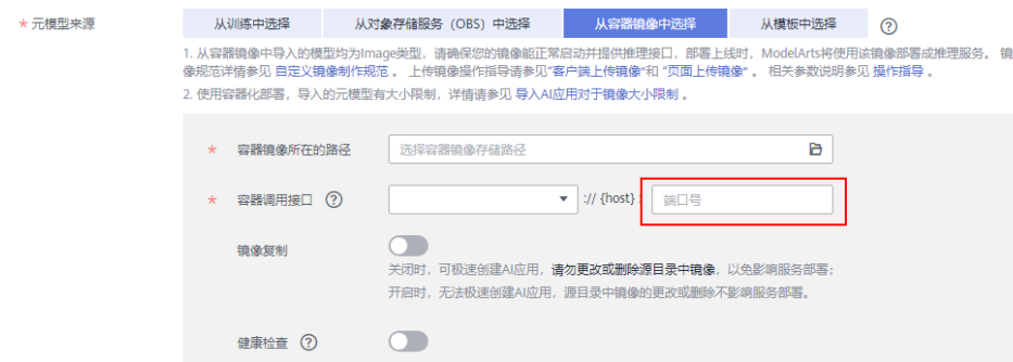
图 5-18 创建 AI 应用界面上配置的端口
