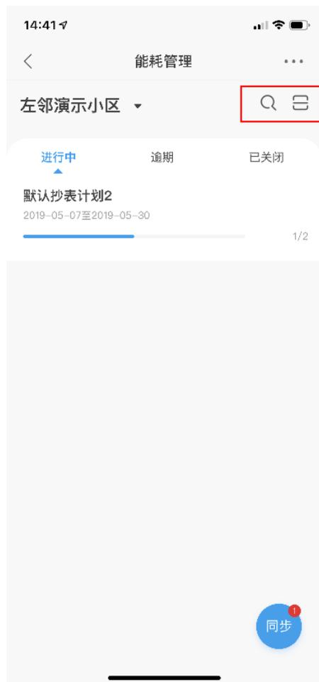
根据关键字查询时，单击“查询”图标进入查询页面。程序可根据关键字对表计名称或表计号码进行模糊查询，选中单个表计后可进入表计读数录入页面，输入读数后提交即可完成。
