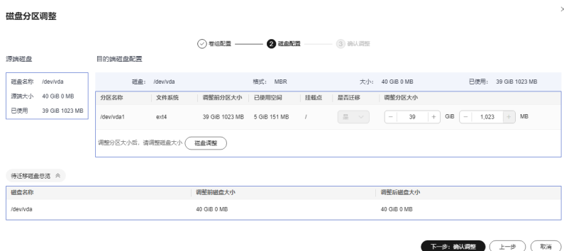
图 7-7 Linux 磁盘分区调整
