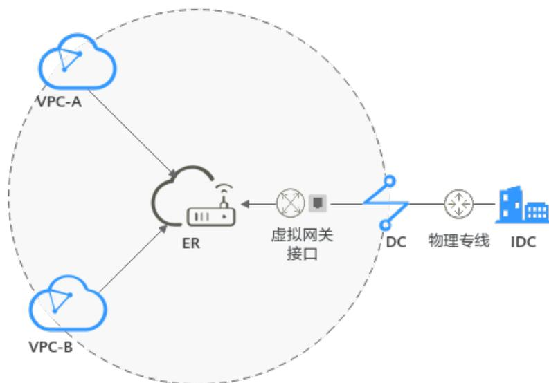
图 1-2 中转 VPC 接入企业路由器组网架构图（方案二）
