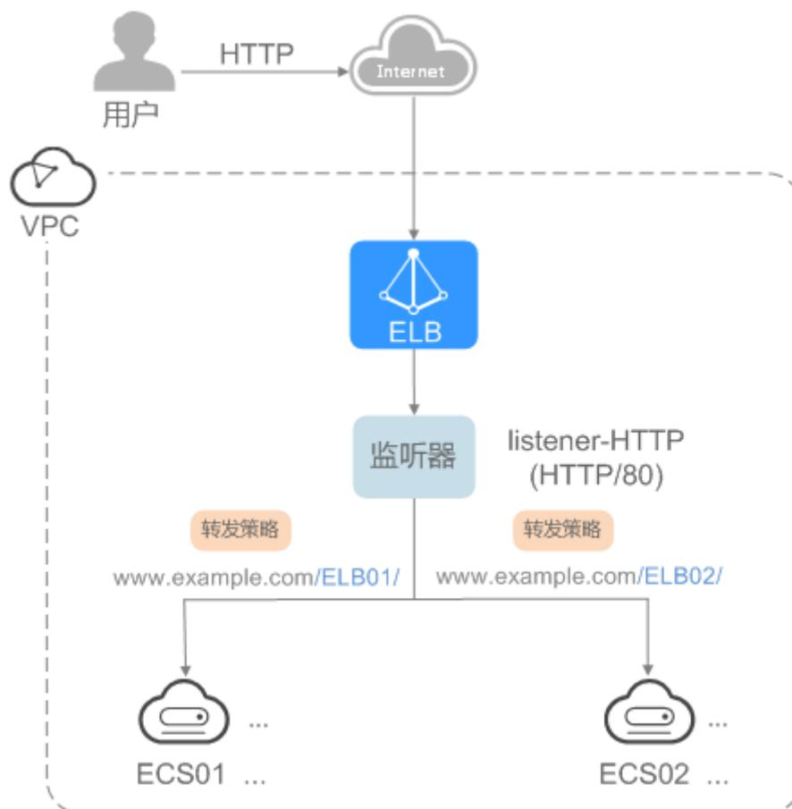
**方案延伸：**可根据业务的实际访问量，将快速入门场景中两个后端服务器组中的弹性云服务器分别扩展到多台，实现后端服务器组内多台弹性云服务器的负载分担。并且负载均衡实例可以通过健康检查，监控弹性云服务器的运行状况，自动将访问流量分发到正常工作的弹性云服务器进行处理，消除单点故障，提升业务的可用性。
