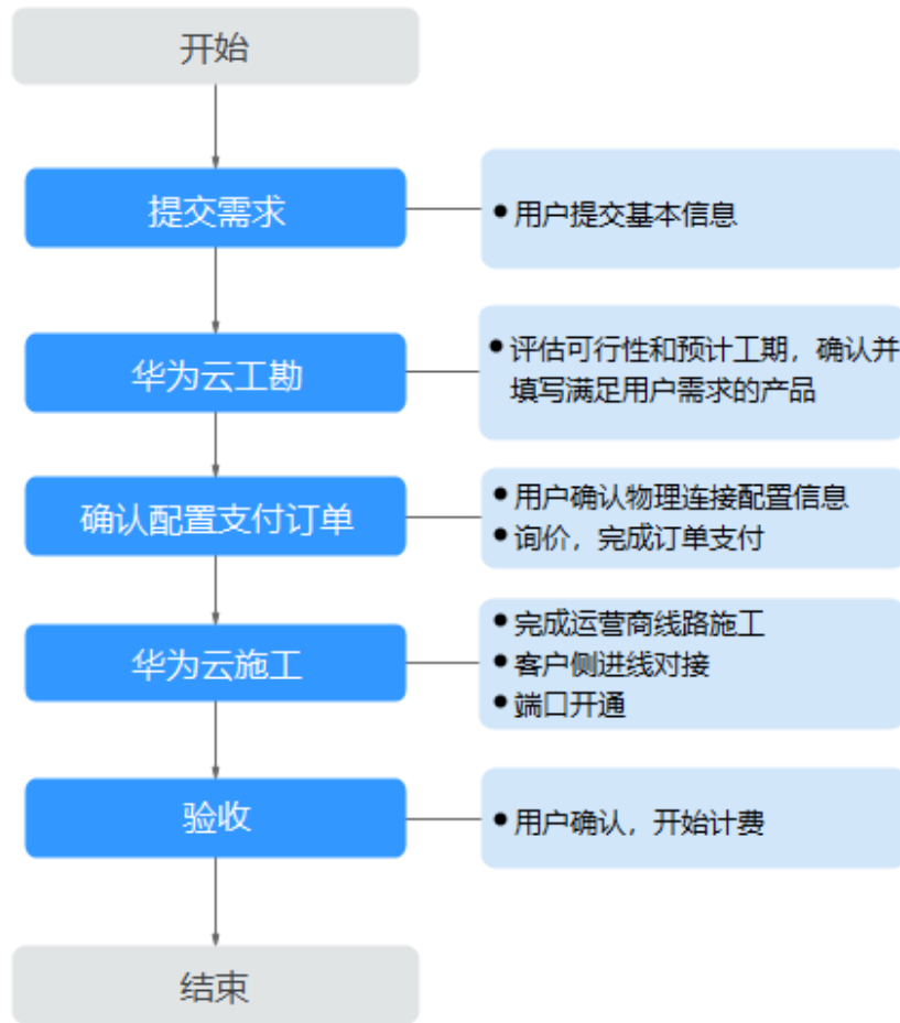
图 3-4 一站式物理连接接入流程
