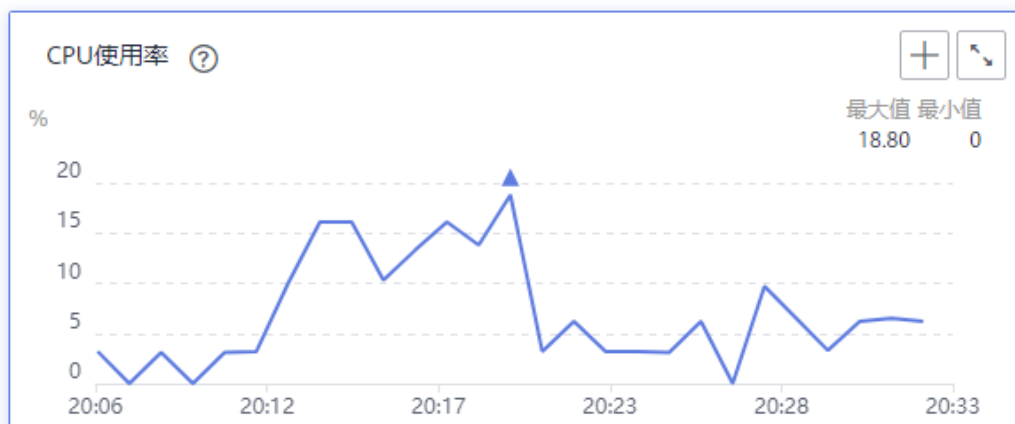
图 3-12 broker-2 的 CPU 使用率（客户端服务器和实例在不同的 AZ 中）
