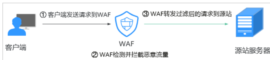
图 1-1 网站接入 WAF 防护原理
