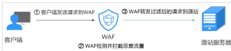
流量经WAF返回源站的过程称为回源。WAF通过回源IP代替客户端发送请求到源站服务器，接入WAF后，在客户端看来，所有的目标IP都是WAF的IP，从而隐藏源站IP。
