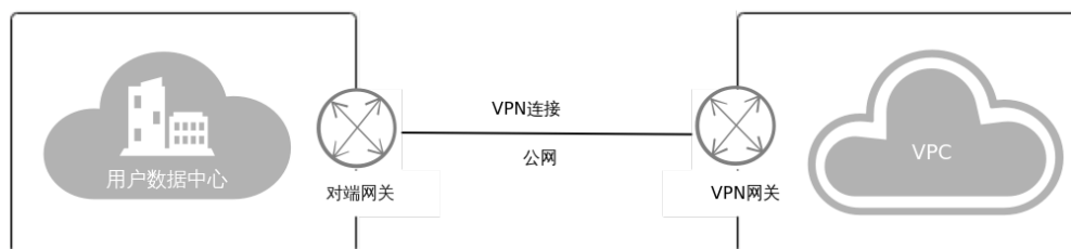
图 2-1 站点入云 VPN 组网图
