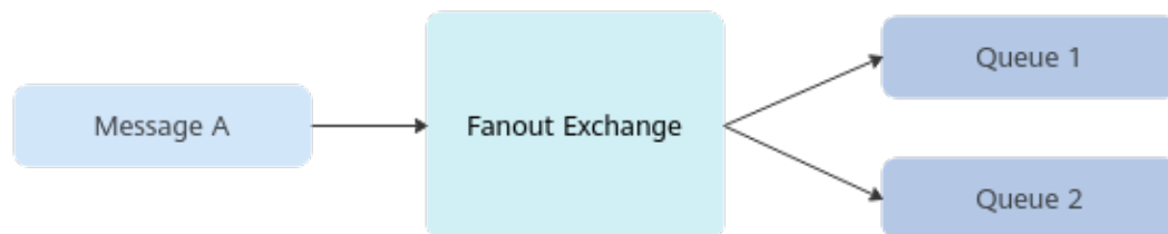
图 13-2 Fanout Exchange 示例
