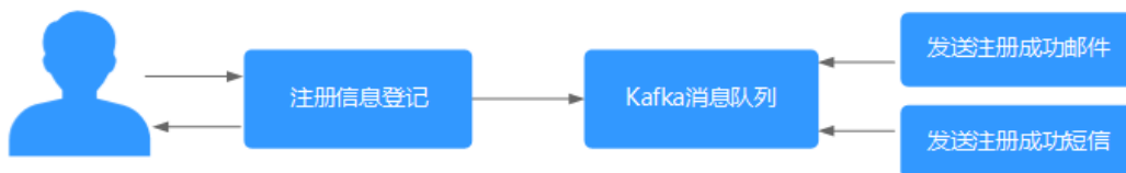
图 3-2 借助消息队列异步发送注册邮件与短信流程
