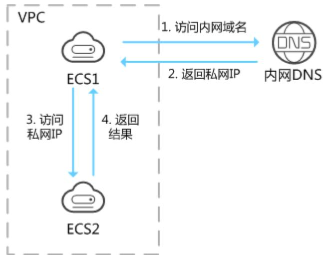
当VPC内云服务器访问内网域名时，内网DNS直接对内网域名进行解析，向云服务器返回对应被访问的云服务器的私网IP地址。
