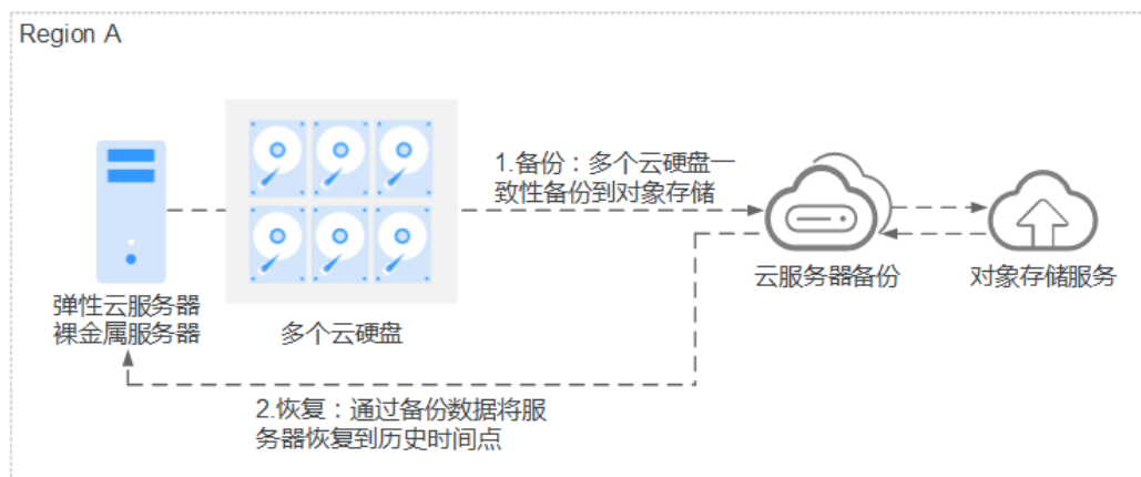
图 1-1 云服务器备份产品架构
