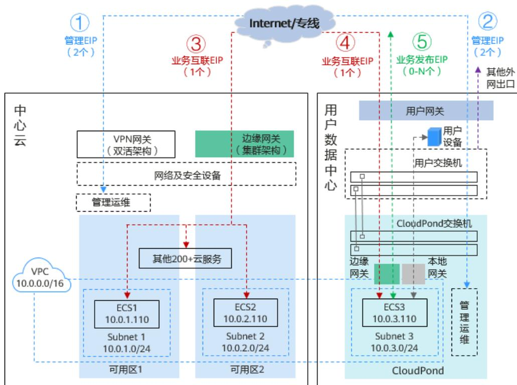
CloudPond和中心云之间通过Internet或者专线连接，您可以通过组网方案图重点了解CloudPond相关的四条网络链路，如[表1 CloudPond网络链路说明](#)所示：
