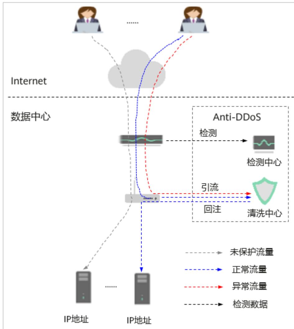
检测中心根据用户配置的安全策略，检测网络访问流量。当发生攻击时，将数据引流到清洗设备进行实时防御，清洗异常流量，转发正常流量。
