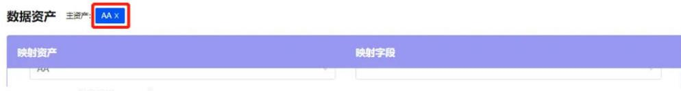
**步骤4** 选择主资产后，配置各组件需绑定的“映射字段”，且必须绑定组件“主键”的“映射字段”，如下图所示，若绑定的字段备注和组件名称相同，则会自动绑定映射关系
