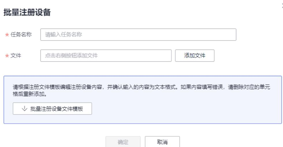
**步骤4** 批量注册执行成功，如果是原生MQTT设备注册，请单击批量任务一行，进入任务的“执行详情”，保存好设备ID和密钥，用于原生MQTT设备接入平台。
