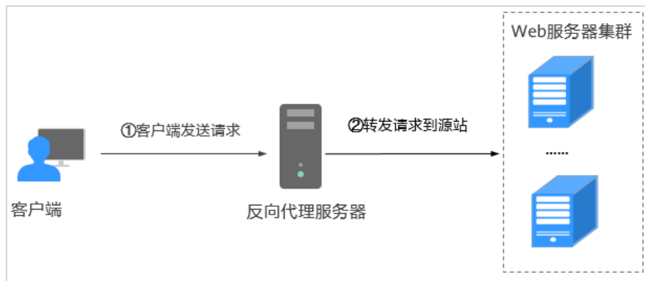
图 2-3 Nginx 转发原理
