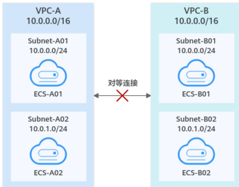
图 5-3 VPC 网段重叠, 且部分子网重叠(IPv4)
