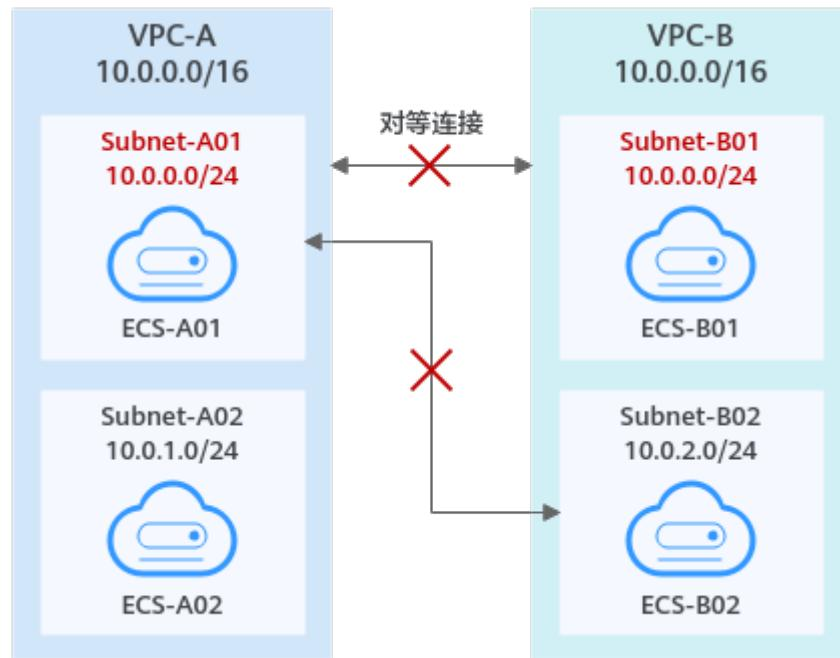
当VPC网段重叠, 且部分子网重叠, 您可以在网段不重叠的子网之间建立对等连接。本示例为创建Subnet-A02和Subnet-B02之间的对等连接, 组网图如图5-4所示, 路由添加方法请参见表5-3。
