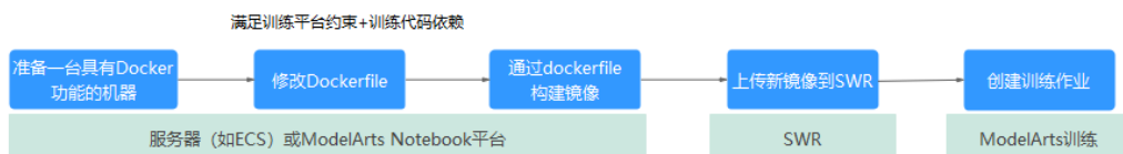
图 8-4 训练作业的自定义镜像制作流程
