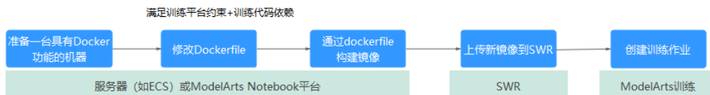
图 10-16 训练作业的自定义镜像制作流程
