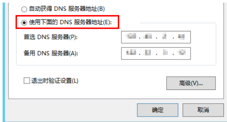
图 3-10 Windows 系统配置 DNS
