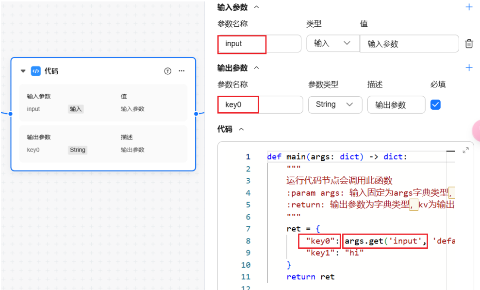
图 7-55 代码节点配置示例
