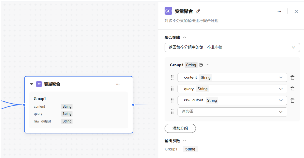
图 7-61 变量聚合节点配置示例
