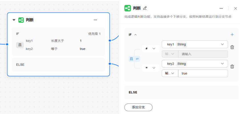
图 7-54 判断节点配置示例
