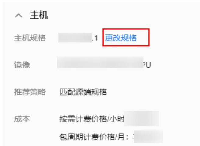
**步骤3** 单击磁盘对应的目的端规格处的“**更改规格**”，可以修改目的端磁盘的存储类型和资源总用量（磁盘容量）。Linux主机的磁盘容量可以根据源端主机磁盘的实际使用量，进行缩容，即小于源端磁盘容量。更改磁盘规格后，系统会自动判断是否进行了磁盘缩容，在主机资源配置明细列表中的“**磁盘缩容**”列，“是”代表已缩容；“否”代表未缩容。
