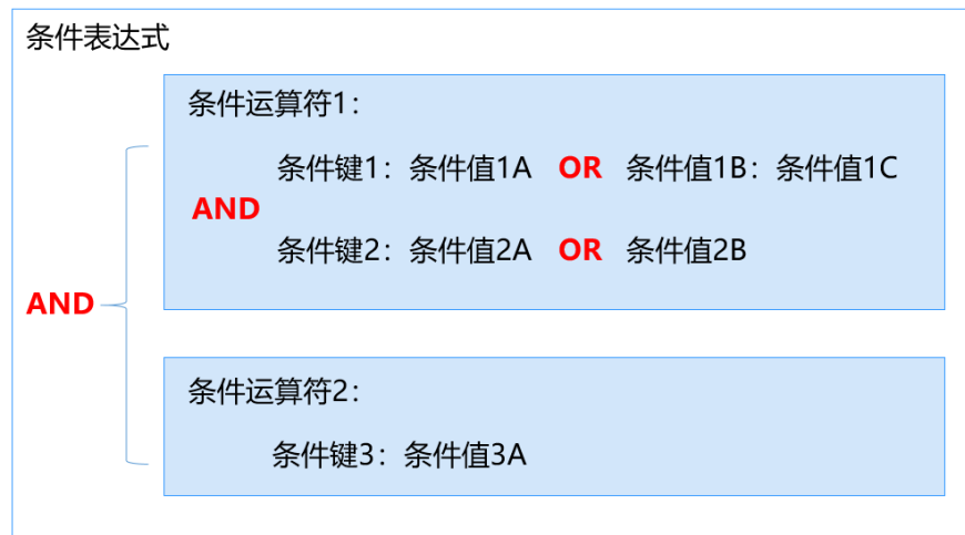
图 5-4 条件键运算逻辑示意图
